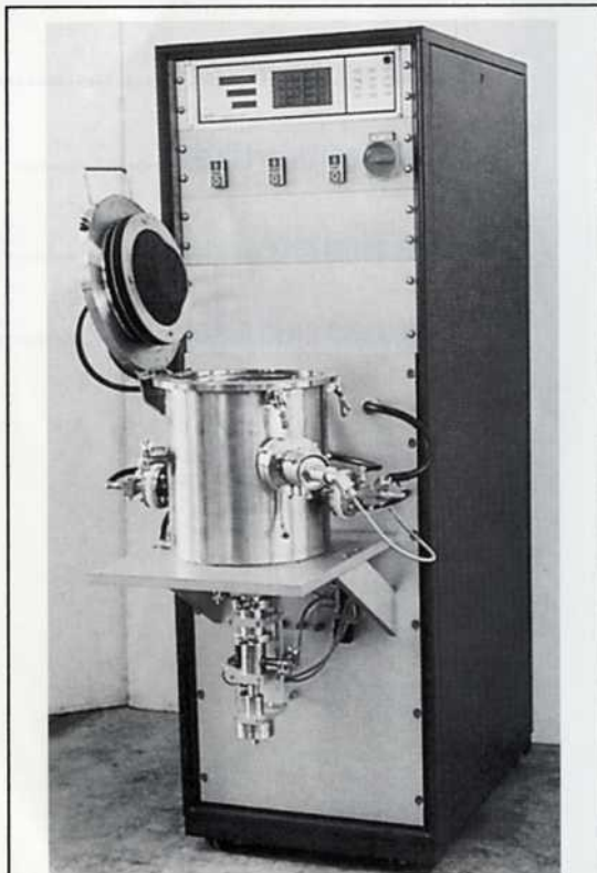
Hochtemperatur-Laborofen bis 2 200 °C
