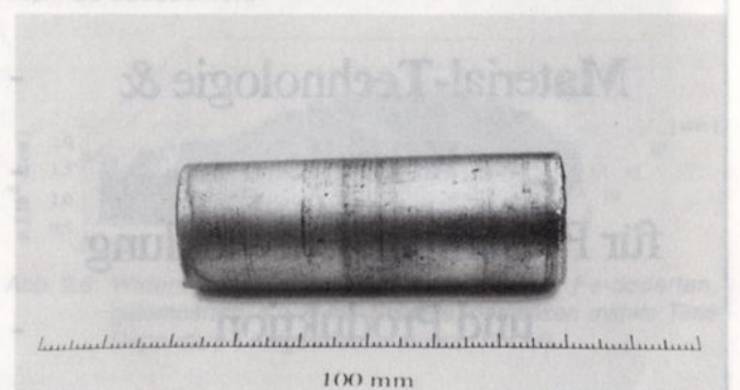
Abb. 3.3: Erster bei 20facher Erdbeschleunigung auf der Zentrifuge mit dem VGF-Verfahren gezüchteter Germanium-Kristall.
