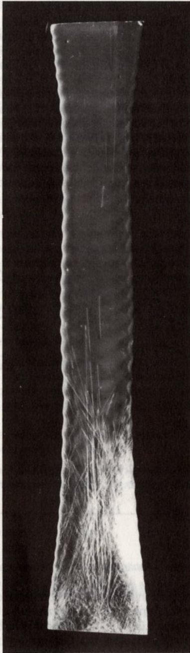
Abbildung 1.4 Röntgentopogramm (5fach vergrößert, Positiv) eines FZ-Si-Dünnhalses mit Ziehrichtung [111] (220-Reflex, \text{MoK}\alpha_1 -Strahlung). Trotz instationärer Züchtung (gewellte Oberfläche), ist der Dünnhals nach der halben Ziehlänge nahezu versetzungsfrei.
