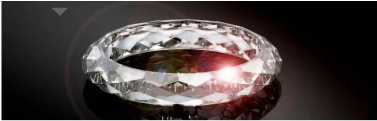
Abb. 4: Volldiamantring mit 133 Facetten (3.87 Karat) hergestellt von Dutch Diamond Technologies (DD) aus einem heteroepitaktischen Diamanten aus Augsburg (Quelle: Ton Janssen, DD).
