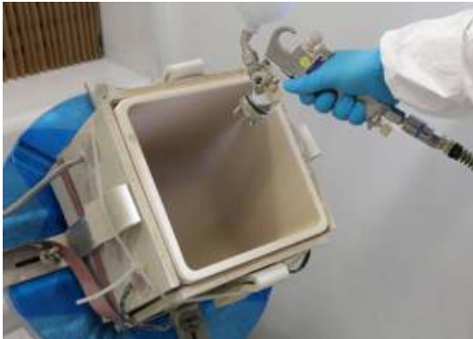
Abb. 1: Herstellung einer Sprühbeschichtung auf einem G1-Tiegel am Fraunhofer IISB im Rahmen des SYNERGIE Projektes Foto: Kurt Fuchs/Fraunhofer IISB
