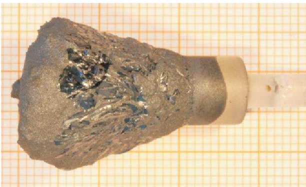
Abb. 3: TSSG - Boule nach 7 Tagen Züchtungsdauer mit gekühltem Saphirkeim.
