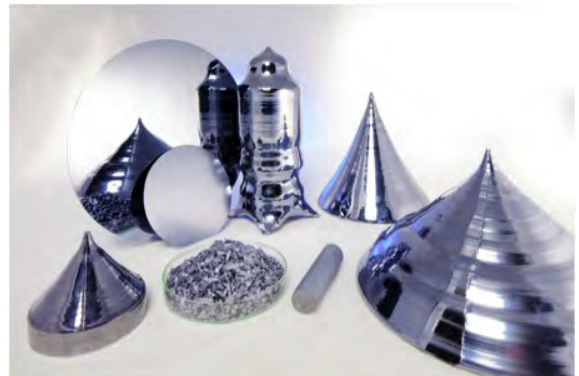
Die Anfangsstücke von Siliciumkristallen mit unterschiedlichen Kristalldurchmesser und daraus gefertigten Wafern sowie das Ausgangsmaterial für die Siliciumkristallherstellung Foto: Fuchs/Fraunhofer IISB
