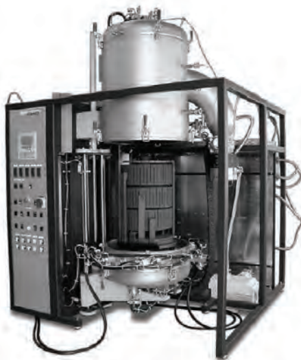
KZV Kristallziehvorrichtung mit Leistungsregelung für Fluoride nach dem Stockbarger- oder Bridgman-Verfahren bis 1800°C
