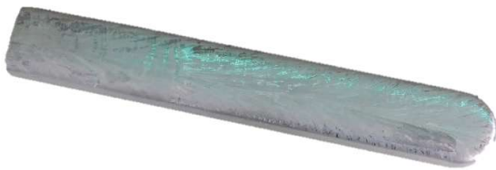
Abb. 1: Polykristalliner InP-Barren von 2,6 cm Breite und 17 cm Länge hergestellt mittels Gasphasentransport bei VEB Spurenmetalle Freiberg 1975-1979. (Foto: Freiburger)
