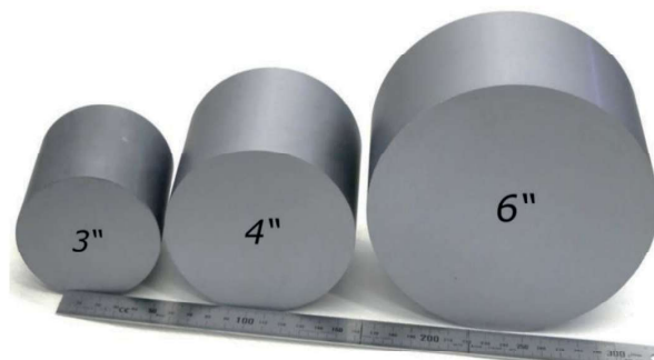
Abb. 4: Rundgeschliffene InP-Kristalle ohne Kopf und Fuß mit Durchmessern von 3", 4" und 6". (Foto: Freiburger)
