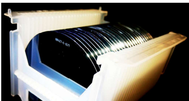
Abb. 3: 100 mm-InP-Wafer in einem Carrier zu 25 Stück. (Foto: Freiburger)
